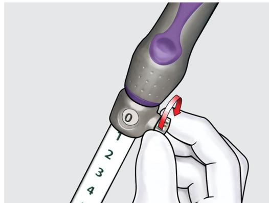
Retraiga la aguja por completo hacia la vaina y bloquee el tornillo de mano en el anillo de seguridad en la marca de 0 cm.
