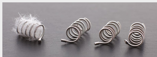
Esta imagen muestra una espiral de platino recubierta de fibras a la izquierda y tres espirales de platino desprovistas de fibras a la derecha.
