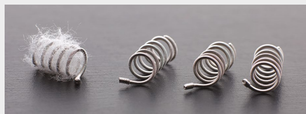
Questa immagine mostra una spirale in platino dotata di fibre sulla sinistra e tre spirali in platino non rivestite sulla destra.
